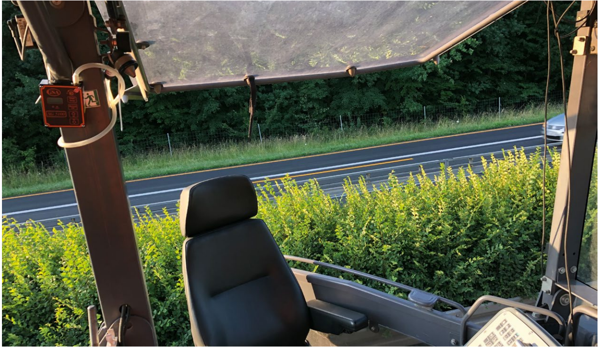
Abbildung 4: Luftprobe am Fahrersitz des Beschickers (Quelle: BG BAU – Berufsgenossenschaft der Bauwirtschaft)
