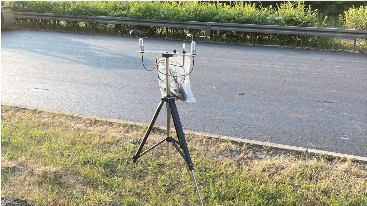
Abbildung 2: Aerosol Messstation (Quelle: Autobahn GmbH Niederlassung Südwest)
