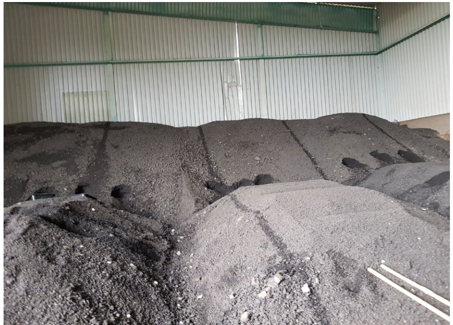
Abbildung 2: Lagerung des gummimodifizierten Asphaltgranulats (Quelle: Ministerium für Verkehr Baden-Württemberg)
